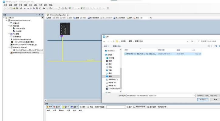
单击 PLC---勾选 EtherCAT 主站 --- 选择左侧设备 ----- 右击 ETHERCAT--- 扫描设备
